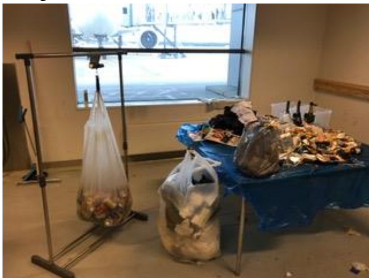
Figur 6 Sorteringstation i Miljörum på Stockholm Arlanda Airport, pir F, som användes för undersökningen. Det sorterade materialet vägdes genom att hänga säcken i vågen på ställningen.
