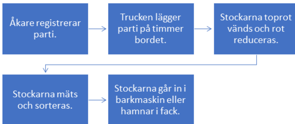
Figur 4. Förenklat flödesschema för timmerplanen.
