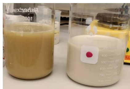
Figur 5 Proteinet före (t.v.) och efter (t.h.) pH justerats till pH 5.
