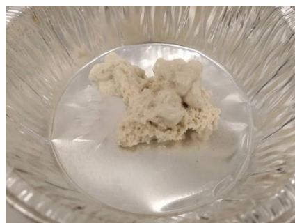
Figur 6 En bild på det skum som bildats efter sonikering vid pH 5 med 800 J/g.
