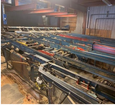
Figur 8. Paketläggaren tömmer facken allteftersom de blir fulla. Virket transporteras sidledes upp till paketläggaren genom elevatorer.
