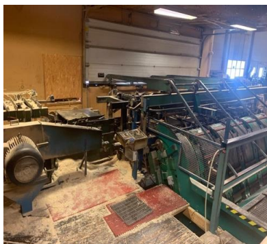
Figur 6. Kantverket som skär av de vassa kanterna på bräder.
