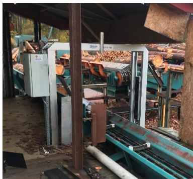
Figur 2. Mätstationen som mäter timret storlek.
