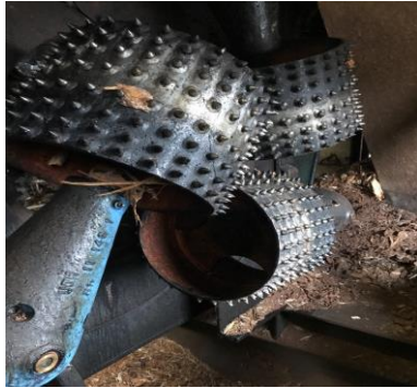
Figur 4. Barkmaskinen som skalar av barken.
