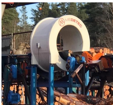
Figur 3. Metalldetektorn som testar stocken för metaller.
