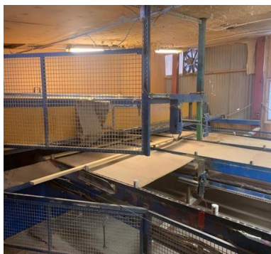
Figur 7. Det sågade virket går genom sorteringsverket som sorterar de sågade bitarna i rätt dimension och kvalitet.
