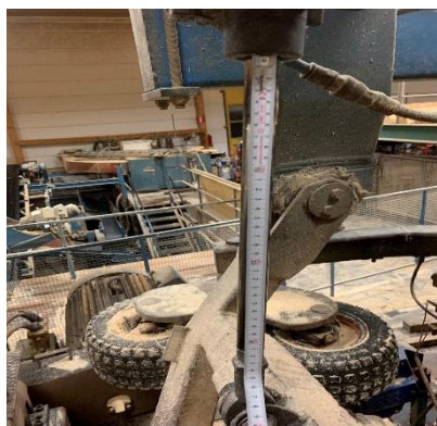
Figur 1. Luftkolv som har uppgift att centrera stockarna så att de går rakt i sågen.
