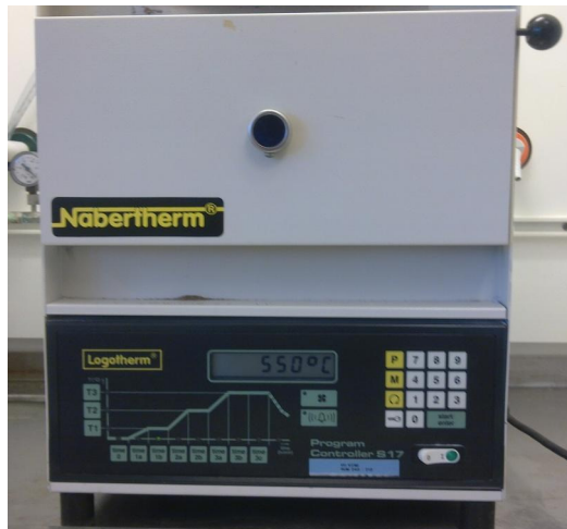
Figur 2. Muffelugn av märket Nabertherm som användes för inaskningen av bränslet.
