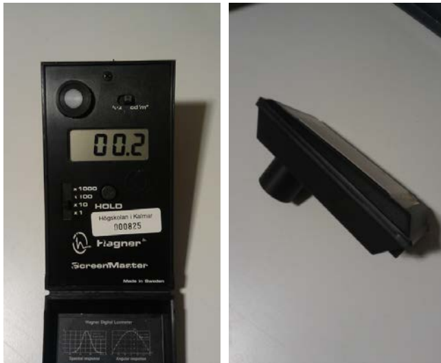
Bild 1.1 och 1.2 Bilderna visar ljusmätaren Hagner Screenmaster.
