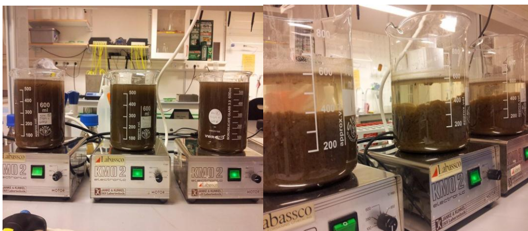
Figur 2.1 Till vänster ses avloppsslammet obehandlat. Högra bilden visar slammet efter polymertillsats, samt 20 min sedimentering. Foto: Ida Angeland
