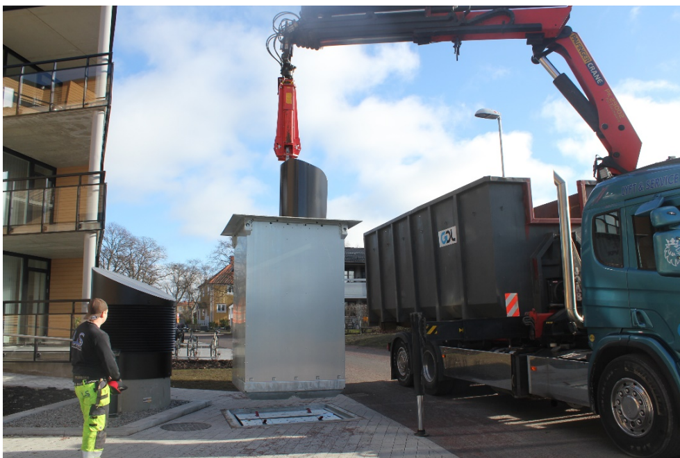
Figur 16. Tömning av underjordisk behållare vid HSB:s fastighet belägen på Södra vägen, Kalmar. Foto: Elin Smith, 25 februari 2016
