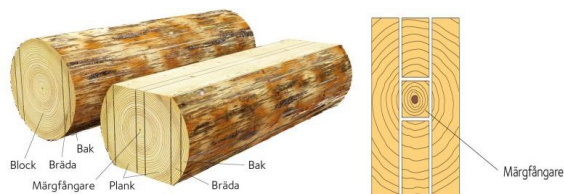
Figur 9: Fyrsågning med märgfångare (Svenskt trä, uå)
