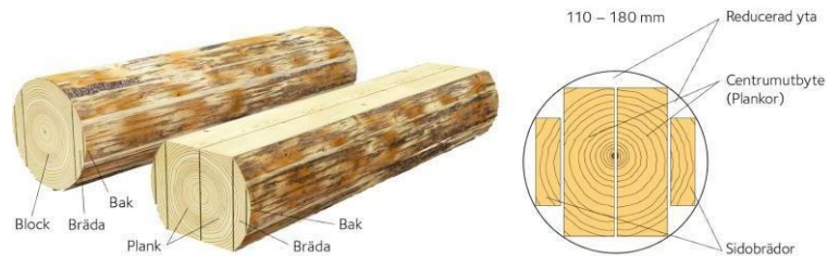
Figur 10: Fyrsågning med centrumsnitt, 2x (Svenskt trä, uå)
